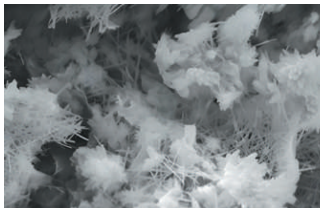
Рис. 4. Микроструктура цемент. камня с добавкой «Пенетрон Адмикс»
